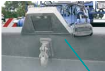
Videokamera, Lasthaken und Beleuchtung sind mittig an der Schaufeloberkante montiert.
