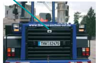
Die dritte Videokamera befindet sich mittig am Fahrzeugheck. Unterhalb der beiden Arbeitsscheinwerfer sind zusätzliche LED-Blitzleuchten angebracht.
