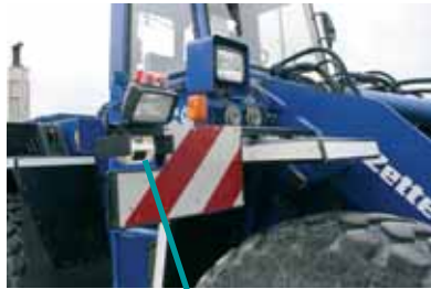
Der Kameraarm wird mit Magneten am rechten Kofflügel befestigt.
