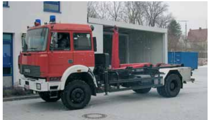
Nach einer zweimonatigen Umbauphase präsentiert sich der IVECO-Wechselader nun in THW-blau anstatt in feuerrot. Das Fahrzeug stammt von der Berufsfeuerwehr München. Auf dem Abrollbehälter Hochwasserschutzsystem wird hinten die Sandschlauchschaufel mitgeführt.
