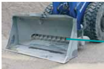
Eine Förderschnecke im Schaufelboden transportiert den Sand zu den Sandschläuchen.
