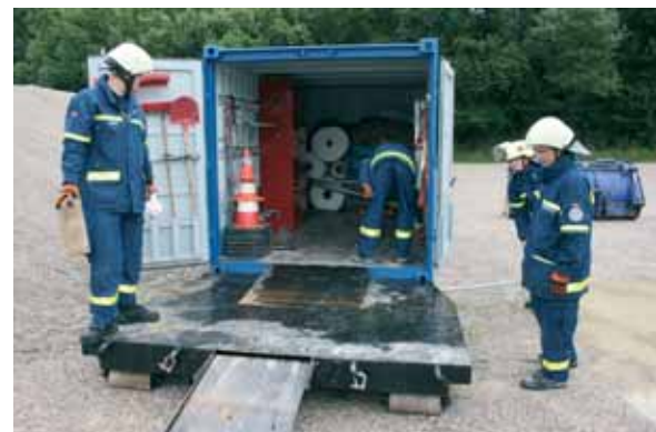
Der Abrollbehälter Hochwasserschutzsystem lässt sich über zwei Auffahrampen bequem be- und entladen.
