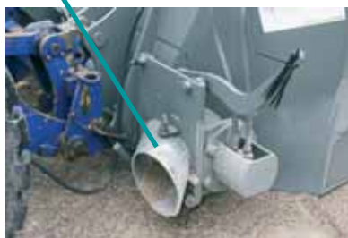
An diesem Stutzen wird das Füllrohr aufgesteckt.
