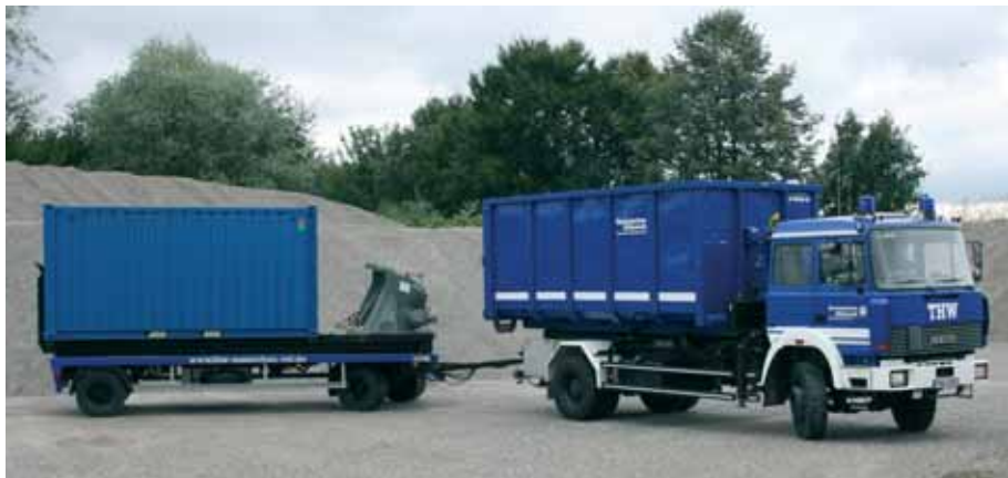
Für das Hochwasserschutzsystem hat das THW München-Ost ein eigenes Fahrzeuggespann beschafft. Wechselladersysteme sorgen für die nötige Flexibilität.
