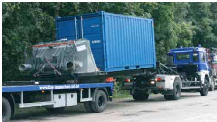
Der Abrollbehälter Hochwasserschutzsystem wird auf einem Anhänger transportiert, der Umsetzvorgang erfolgt über das Wechselladerfahrzeug.
