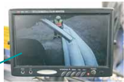
Über einen Monitor hat der Fahrer das Geschehen rechts vom Fahrzeug jederzeit im Blick.
