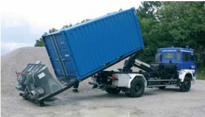
Nach einer zweimonatigen Umbauphase präsentiert sich der IVECO-Wechselader nun in THW-blau anstatt in feuerrot. Das Fahrzeug stammt von der Berufsfeuerwehr München. Auf dem Abrollbehälter Hochwasserschutzsystem wird hinten die Sandschlauchschaufel mitgeführt.
